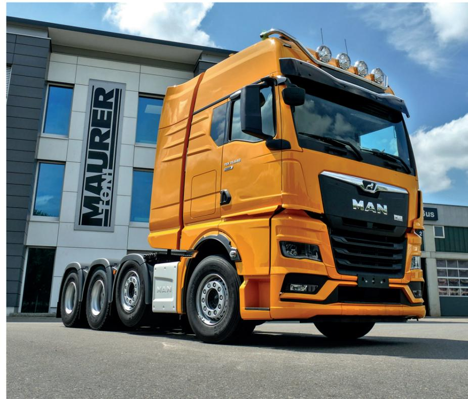
Neben den originalen 4-achsigen MAN-Sattelzugmaschinen mit Radstand 4.040 mm zwischen Achse 1 und 3 können wir ihnen speziell angefertigte kurze 4-Achser anbieten. #
